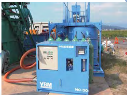
アルカリ性排水中和 (炭酸ガスUFB) NC-30 NETIS(新技術情報提供システム)登録
